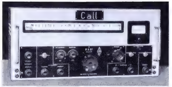
Bild 1. Die Frontplatte des Emp-fängers RX 57 mit dem Stations-Rufzeichen, der beleuchteten Walzenskala, dem S-Meter und den übersichtlich beschrifteten Bedie-nungsorganen
