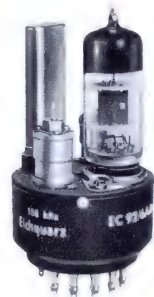
Bild 5. Der als Einsteckeinheit (für eine zehnpolige Stahlröhrenfassung) ausgeführte Eichgenerator
